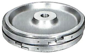
Eisenkolben aus der 1-PS-Gasmaschine von Jean I. E. Lenoir Baujahr 1860 Durchmesser 195 mm Gewicht 5500 g
