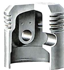
Der erste serienreife geschmiedete Leichtmetallkolben auf dem Kontinent von MAHLE hergestellt Baujahr 1921 Durchmesser 79,5 mm Gewicht 370 g
