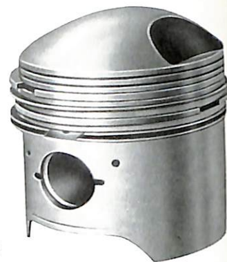
126 Geschmiedeter Kolben aus NSU-Weltrekord-Motorrad 1956, 63 mm
