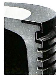
MAHLE-Kolben mit Ringträger und Bodenrandschutz aus austenitischem Sondergußeisen Baujahr 1932 Durchmesser 110 mm Gewicht 1600 g
