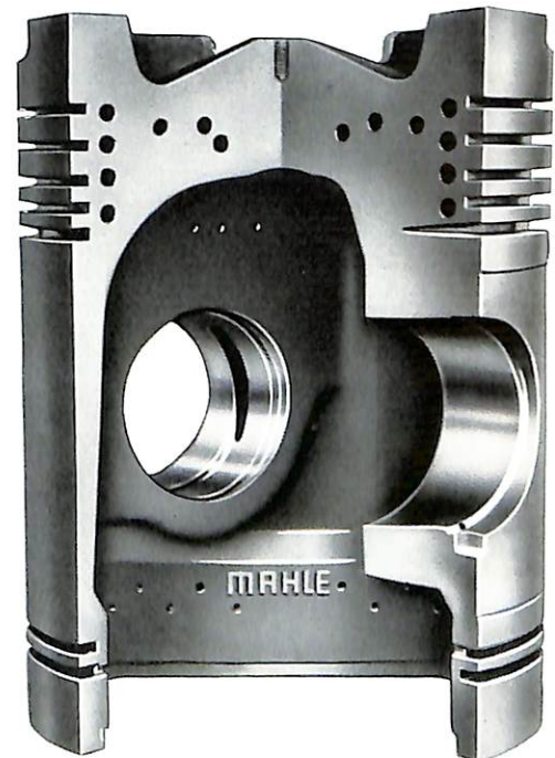
Kolben für Triebwagen-Diesel mit eingegossener Kühlschlange Baujahr 1953 Durchmesser 323.85 mm Gewicht 45 700 g
