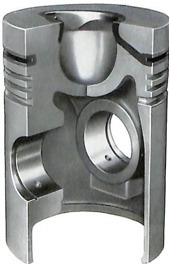
MAHLE-Armalkolben mit Ringträger und angegossenem Muldenrandschutz Baujahr 1963 Durchmesser 121 mm Gewicht 2400 g
