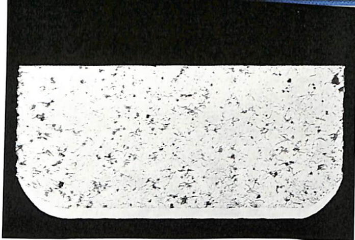
151 Querschnitt durch einen Kompressionsring mit verchromter Lauffläche (V = 50:1)
