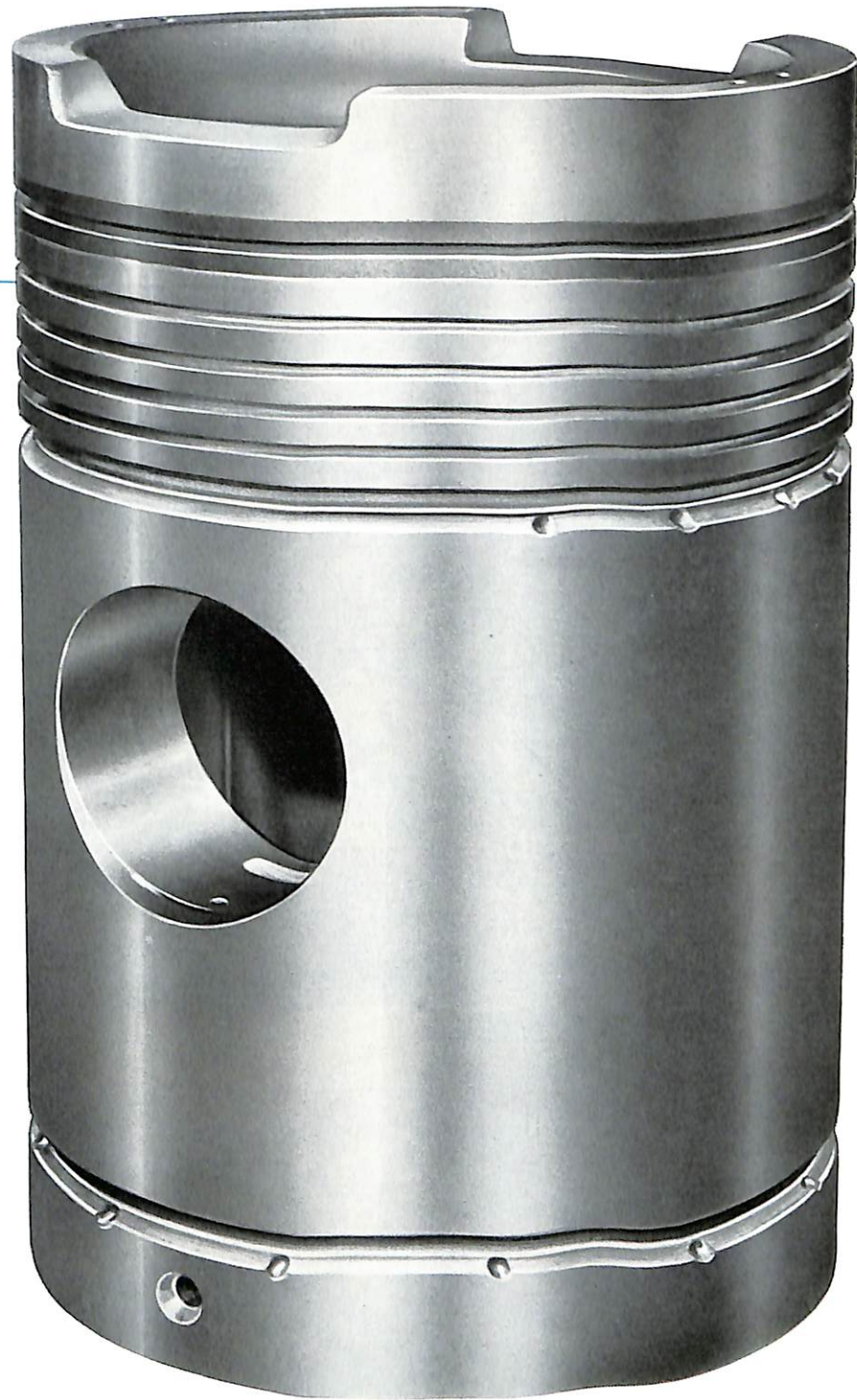
MAHLE-Großkolben mit Ringträger und eingegossener Kühlschlange für Großdieselmachine Baujahr 1958 Durchmesser 400 mm Gewicht 112 500 g
