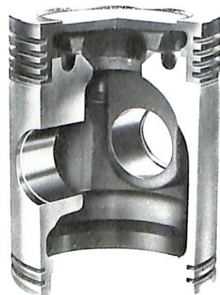
»Gebauter« Kolben geteilt mit Trennebene unter dem Kolbenboden Baujahr 1963 Durchmesser 115 mm Gewicht 2900 g
