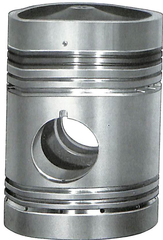
MAHLE-Ringträgerkolben mit eingegossener Kühlschlange für Triebwagendiesel Baujahr 1953 Durchmesser 228,6 mm Gewicht 18 750 g
