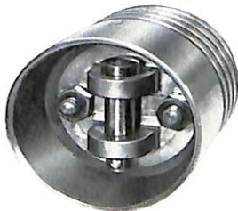
Eisenkolben aus dem ersten Automobil von Carl Benz mit 1,7 PS-Motor Baujahr 1885 Durchmesser 90 mm Gewicht 2200 g
