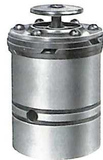
Eisenkolben aus dem ersten Motorrad der Welt von Gottlieb Daimler Baujahr 1885 Durchmesser 58 mm Gewicht 450 g
