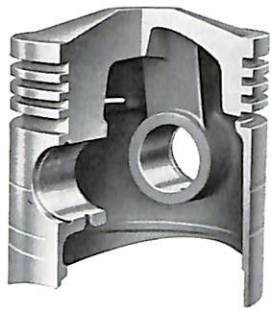
100 Stützstege zwischen Boden und Naben mit der Ringzone verbunden
