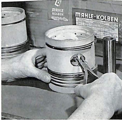
158 Einsetzen von Drahtsprengringen mit Spezialzange
