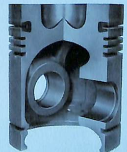
132 AL-FIN-gebundener Ni-Resist-Ringträger für Volvo-Diesel, Typ D 96 AS, 1957
