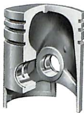
MAHLE-Isostatik-Kolben mit rippenfreier Ringzonenwand Baujahr 1954 Durchmesser 65 mm Gewicht 275 g
