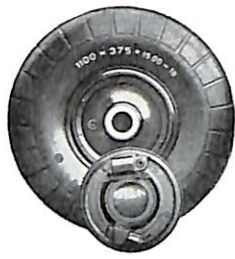
20 Erstes bremsbares Magnesium- Flugzeugrad der Welt
