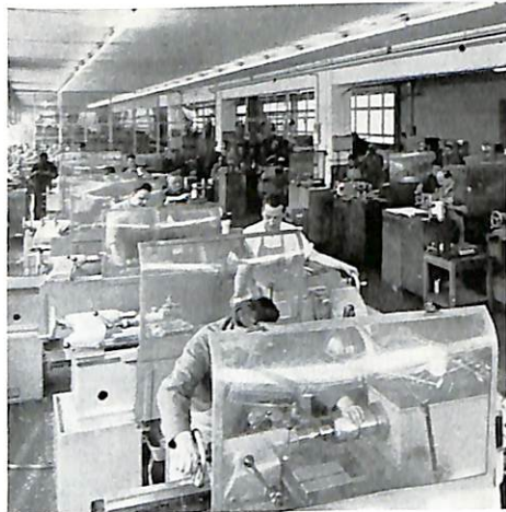
67 Bearbeitungsstraße für Spezialkolben
