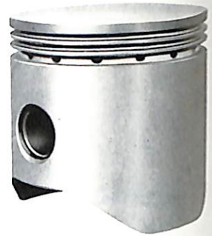
82 Gußeisenkolben für Chevrolet-Personenwagen, eingebaut bis 1952
