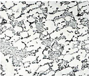
»MAHLE 124« die weltweit verbreitete gieß- und schiedbare eutektische Aluminium- Silizium-Kolbenlegierung entwickelt 1933
