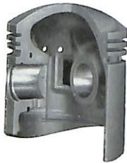
MAHLE-Autothermatikkolben der erste Regelstreifenkolben ohne Trennschlitze zwischen Kopf und Schaft Baujahr 1955 Durchmesser 74 mm Gewicht 340 g
