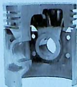
23 Autothermik-Kolben mit Eisenstreifen 1935
