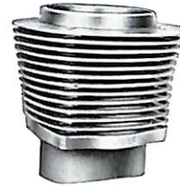
31 Der erste serienmäßige Aluminium-Chrom-Zylinder der Welt im Fahrzeugbau 1950
