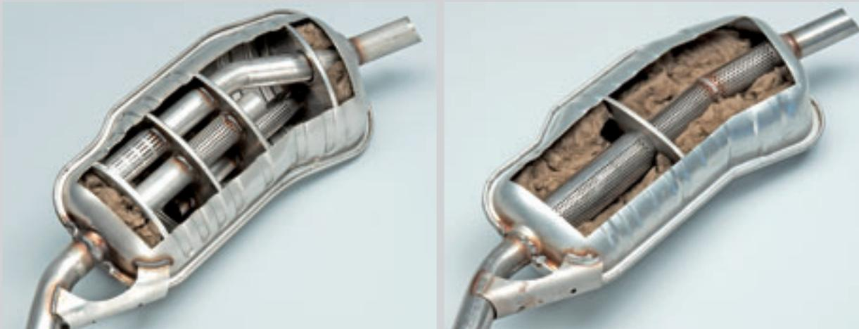
Direkter Vergleich: Links der Schalldämpfer aus dem Programm der Original BMW Teile, rechts ein Produkt der Firma Walker.
