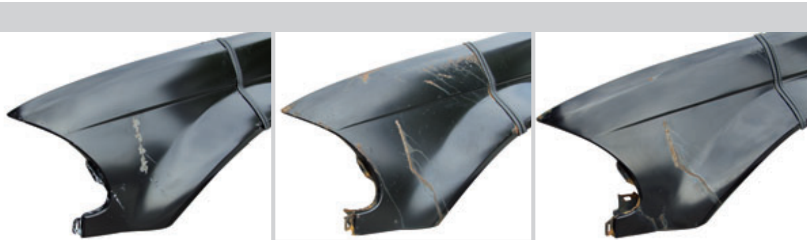
Erhebliche Unterschiede im direkten Vergleich: die Seitenwand als Original BMW Teil (links), von Rhibo (Mitte) und van Wezel (rechts).
