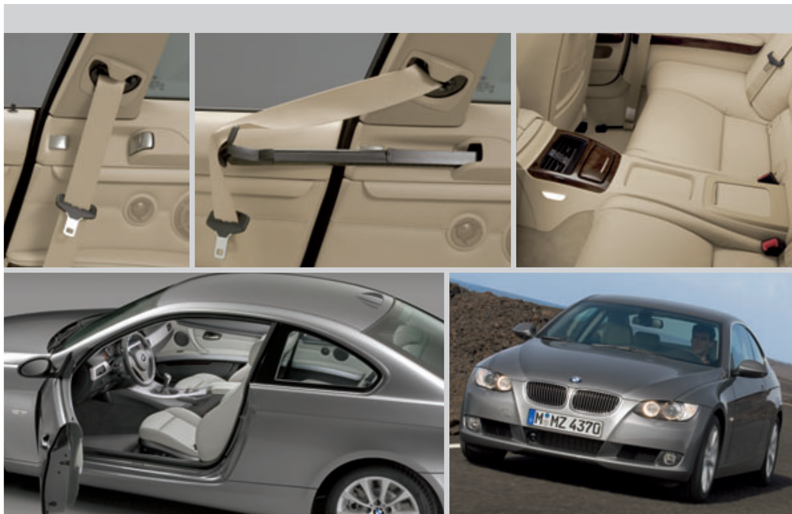
Ganz schön praktisch: Der E92 bietet Platz für vier Personen und hilft den vorderen Passagieren beim Einsteigen mit einem neuartigen Gurtbringer.
