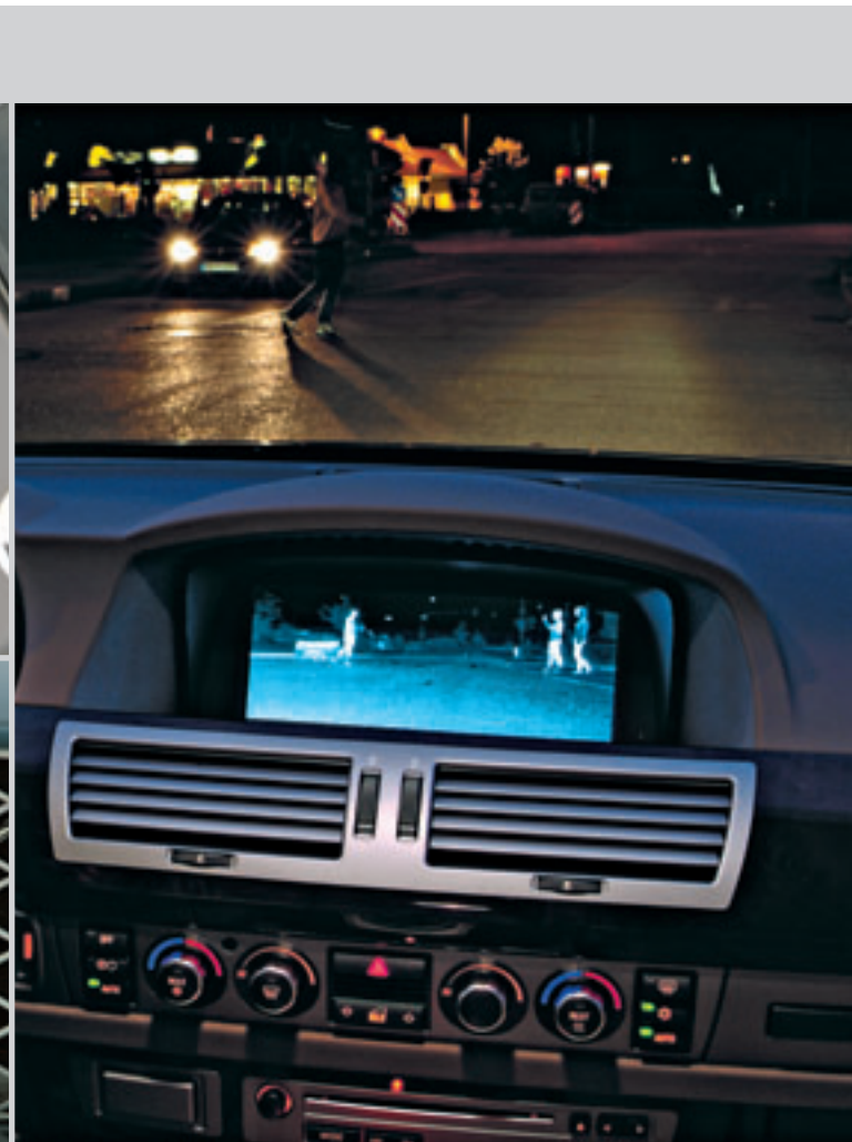
In der schematischen Darstellung des Monitors werden warme Objekte weiß hervorgehoben, wodurch optische Blendeffekte entgegenkommender Fahrzeuge kompensiert werden.
