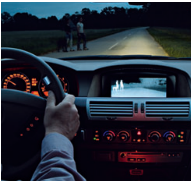
Klares Bild: Das Infrarotsystem macht Menschen und Tiere in Entfernungen von bis zu 300 Metern sichtbar.
