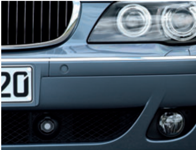
Unauffällig und leistungsstark: Die Infrarotkamera ist im Lufteinlass unterhalb des Nummernschildes platziert.
