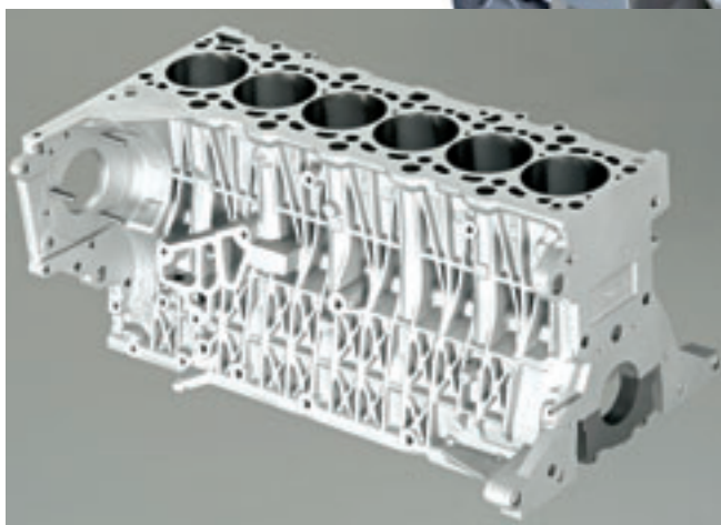
Leichtbau: Die Verwendung eines Aluminium-Gehäuses ohne verstärkende Inlays spart beim Sechszylindermotor M57TU2 rund 25 Kilogramm Gewicht.
