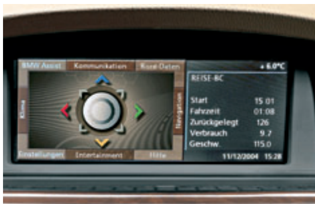
Bediensystem überarbeitet: Das iDrive besitzt nun eine optimierte Menüführung und -darstellung sowie einen direkten Zugang zu einigen Entertainment-Funktionen.
