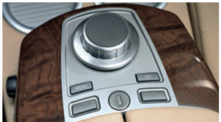
Bediensystem überarbeitet: Das iDrive besitzt nun eine optimierte Menüführung und -darstellung sowie einen direkten Zugang zu einigen Entertainment-Funktionen.
