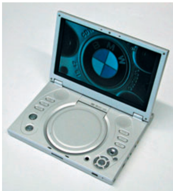
Zweiteilig: Das BMW DVD-System Portable besteht aus einem mobilen DVD-Spieler (links) und einem festen Einbausatz für den Dachhimmel.
