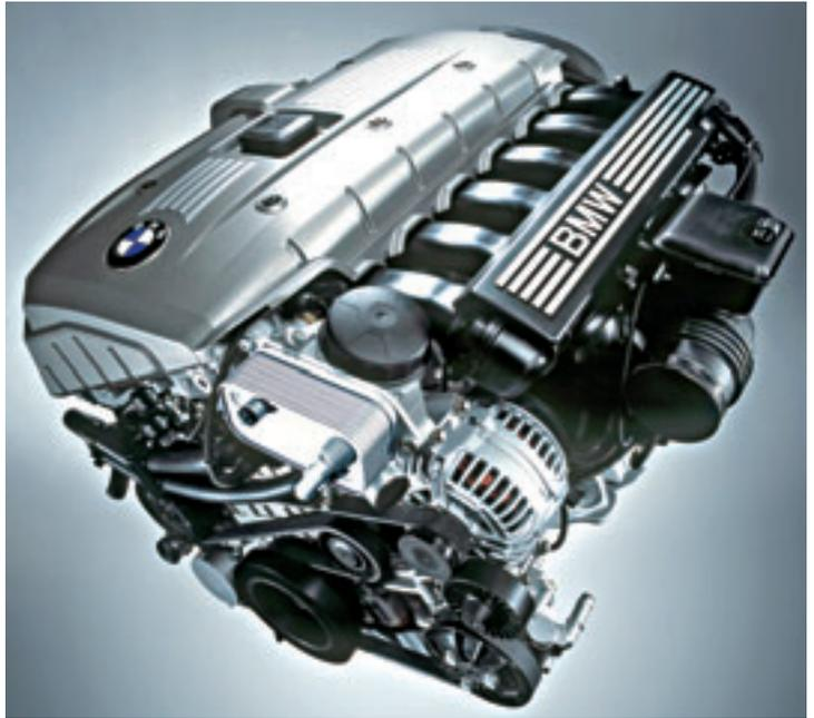
Der Leichteste und Stärkste seiner Klasse: Für das Kurbelgehäuse des N52-Motors mit drei Litern Hubraum und 258 PS wird Magnesium verwendet.
