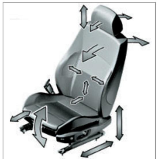
Neue Lösung: Beim E90 kommt erstmals eine elektro-pneumatische Verstellung der Sitzlehnenbreite zum Einsatz.
