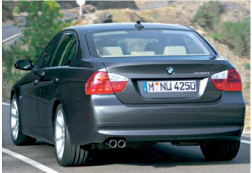
Mehr Sicherheit vor Auffahrunfällen: Bei Notbremsungen vergrößert sich die aktive Fläche der Bremsleuchten.
