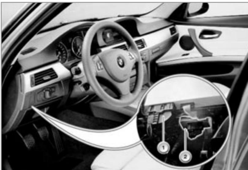
Zentrale Steuerung für die Geschwindigkeitsregelung: Das LDM-Steuergerät ist im Innenraum links unter der Armaturentafel eingebaut (1= Car Access System, 2= LDM-Steuergerät).
