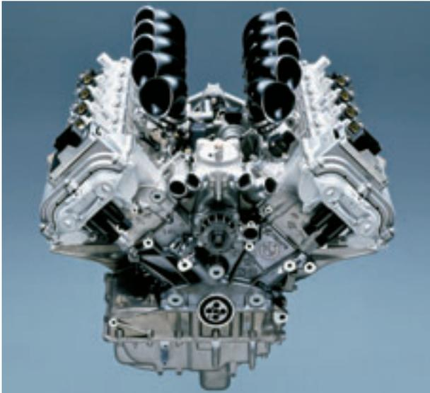
Anleihen aus der Formel 1: zehn Zylinder im 90-Grad-Winkel, einzelne Lufttrichter aus leichtem Verbundwerkstoff für jeden Zylinder.
