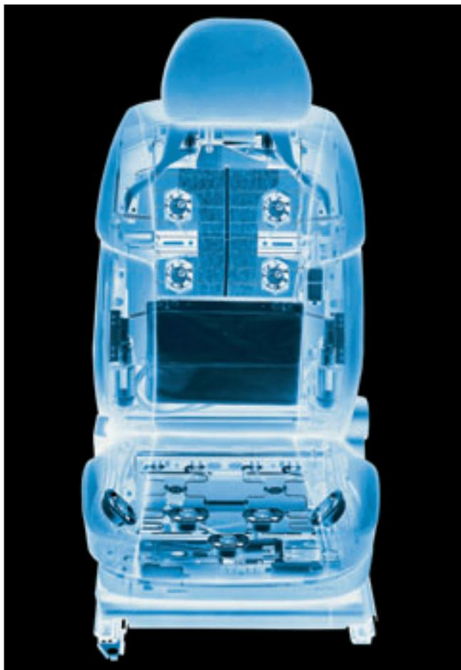
Der neue M-Multifunktionsstuhl im Röntgenbild: Vollelektrische Verstellung, Heizung und Lüftung integriert.
