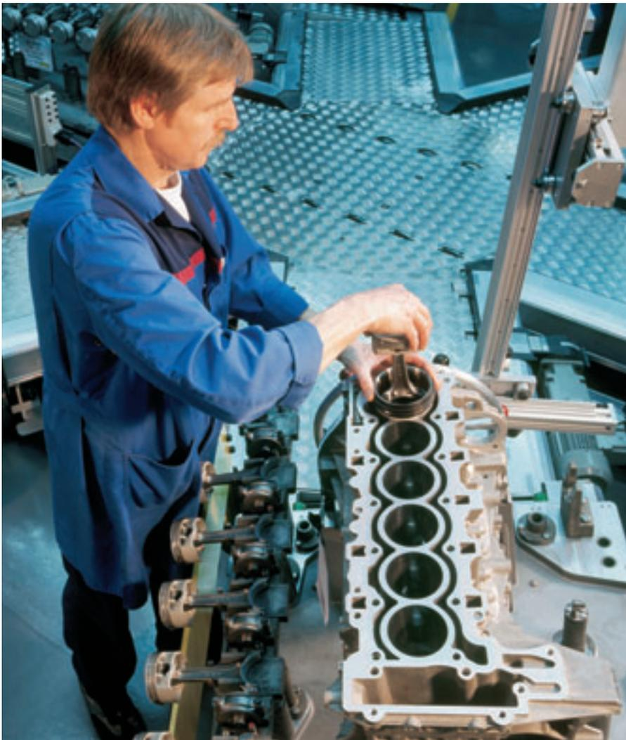
Handarbeit, die nicht zu ersetzen ist: Einsetzen der Kolben in den Motorblock von oben.
