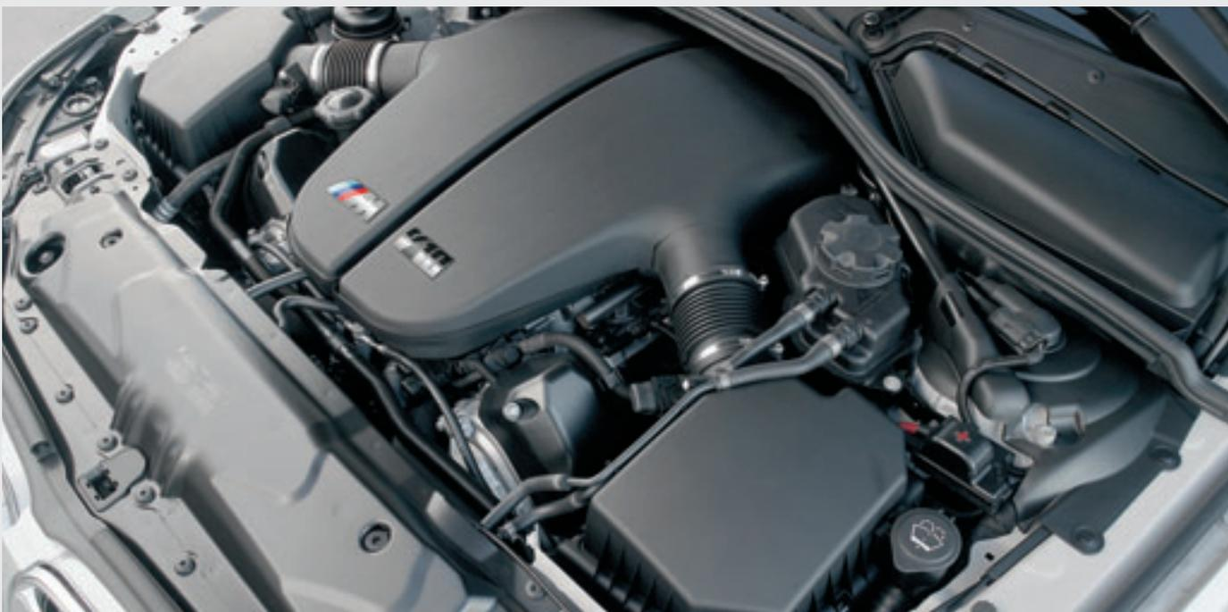
V10-Motor im BMW M5: Das neue Triebwerk besitzt die Motorsteuerung MSS65, für die eine neue Diagnose erstellt wurde.
