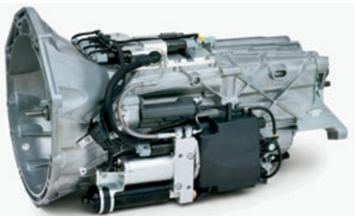
Erstmals sieben Gänge: Das neue 7-Gang-SMG ist eine komplette Neukonstruktion. Die Schaltaktuatorik und die Hydraulikeinheit sind nun im Getriebegehäuse integriert.
