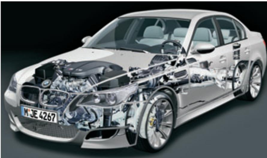
Enorme Dynamik beherrschbar gemacht: Das Fahrwerk entspricht in den Grundzügen dem normalen 5er, wurde aber in zahlreichen Details modifiziert und an die Anforderungen der hohen Leistung des M5 angepasst.
