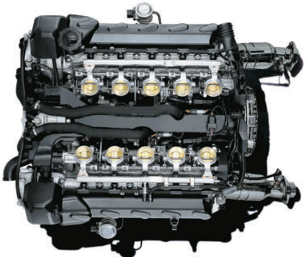
Ein Augenschmaus für Technik-Fans: V10-Triebwerk im Teilschnitt von oben. Man erkennt sehr gut die zehn elektronisch gesteuerten Einzeldrosselklappen.
