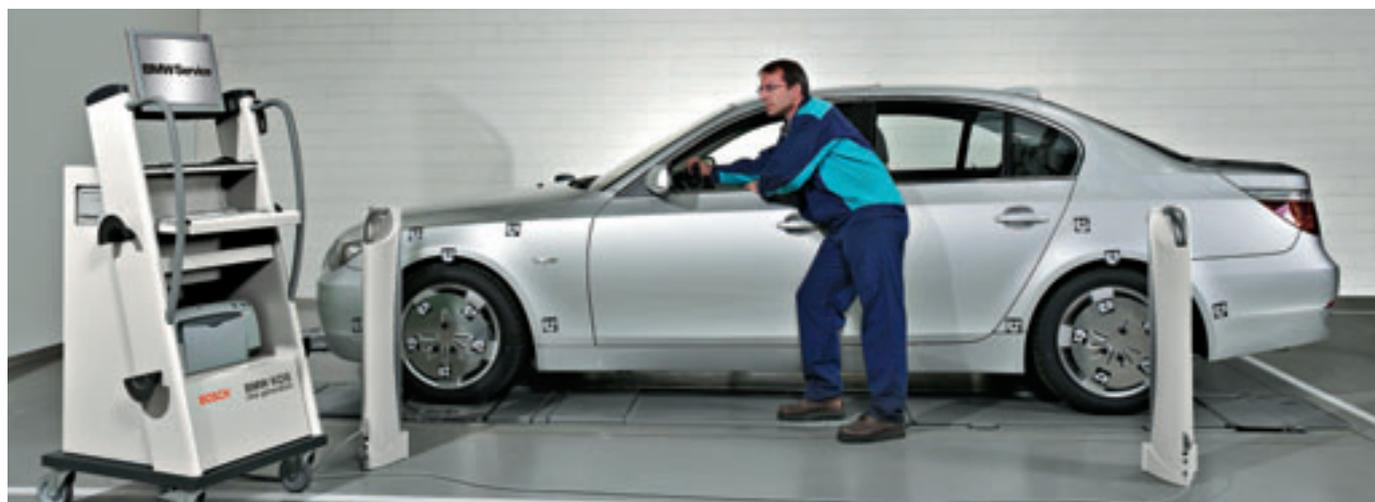
Achsvermessung mit minimalem Aufwand: Hochleistungskameras erfassen alle relevanten Daten.
