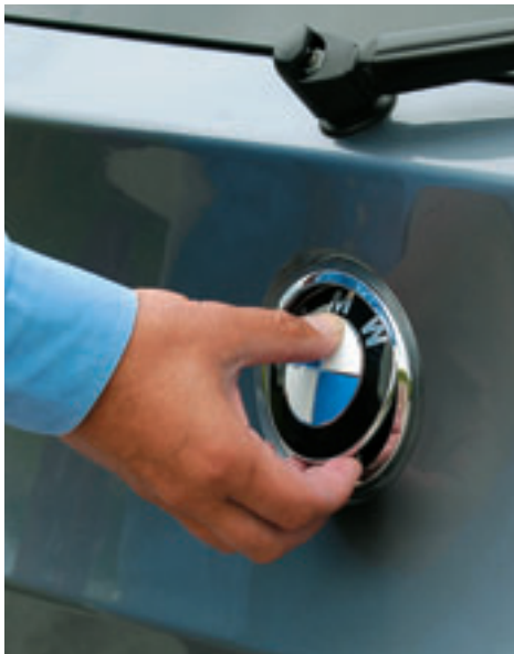
Stil im Detail: Das BMW Logo dient als praktischer Öffner für die Heckklappe.
