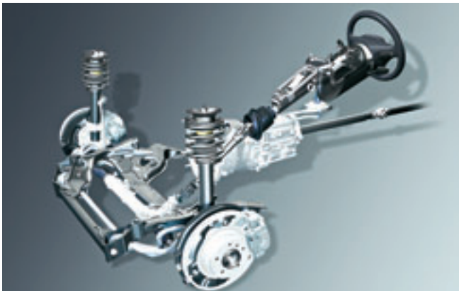
Wie beim großen Bruder: Die Vorderachse aus Aluminium entspricht im Wesentlichen der Radaufhängung des E60.
