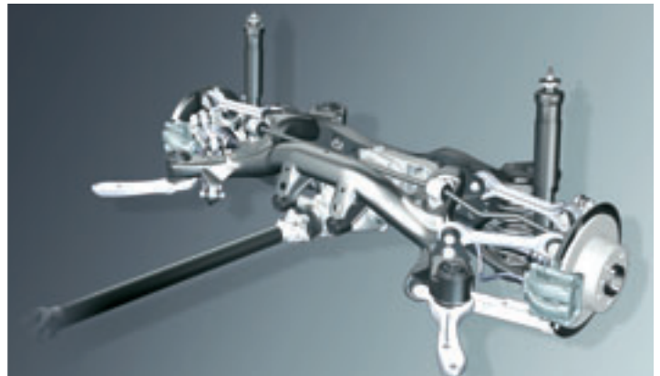
Neuentwicklung: Die HA5-Hinterachse mit fünf unabhängigen Lenkern pro Rad sorgt für erstklassige Fahreigenschaften.
