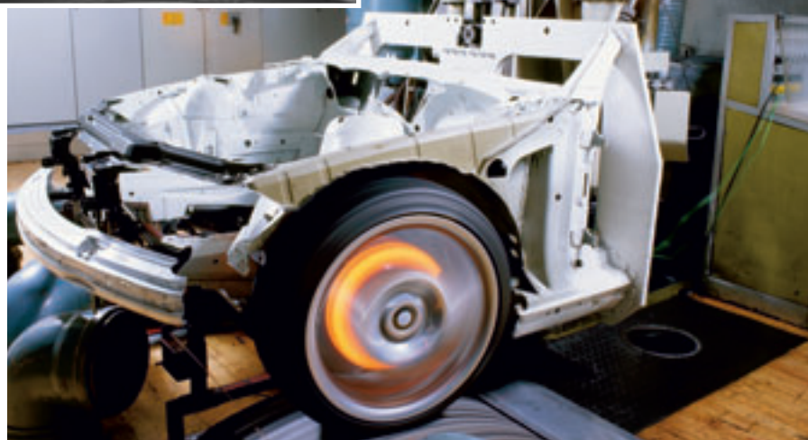
Der kleine Stern bürgt für Qualität: Bevor Reifen dieses BMW Symbol erhalten, werden sie in zahlreichen Versuchen auf der Straße und auf dem Rollenprüfstand getestet.
