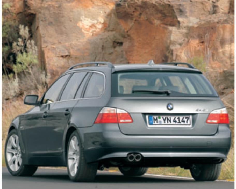
Markantes Heck: Die relativ schmale Heckscheibe lässt sich wie beim Vorgänger separat öffnen. Als Extra gibt es einen vollautomatischen Öffnungs- und Schließmechanismus für die ganze Heckklappe.
