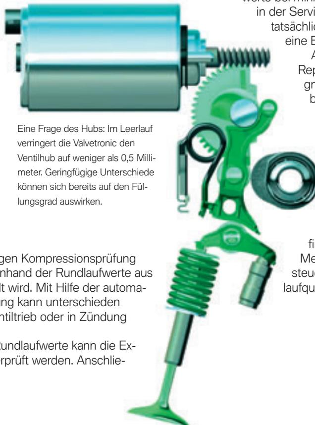
Eine Frage des Hubs: Im Leerlauf verringert die Valvetronic den Ventilhub auf weniger als 0,5 Millimeter. Geringfügige Unterschiede können sich bereits auf den Füllungsgrad auswirken.
