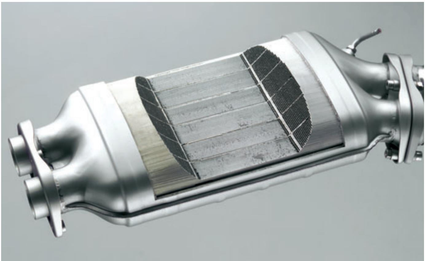
Kernstück des Systems: Der Partikelfilter mit einem Volumen von 4,5 Litern besteht aus einem Keramikmonolithen, der katalytisch auf Platinbasis beschichtet ist.
