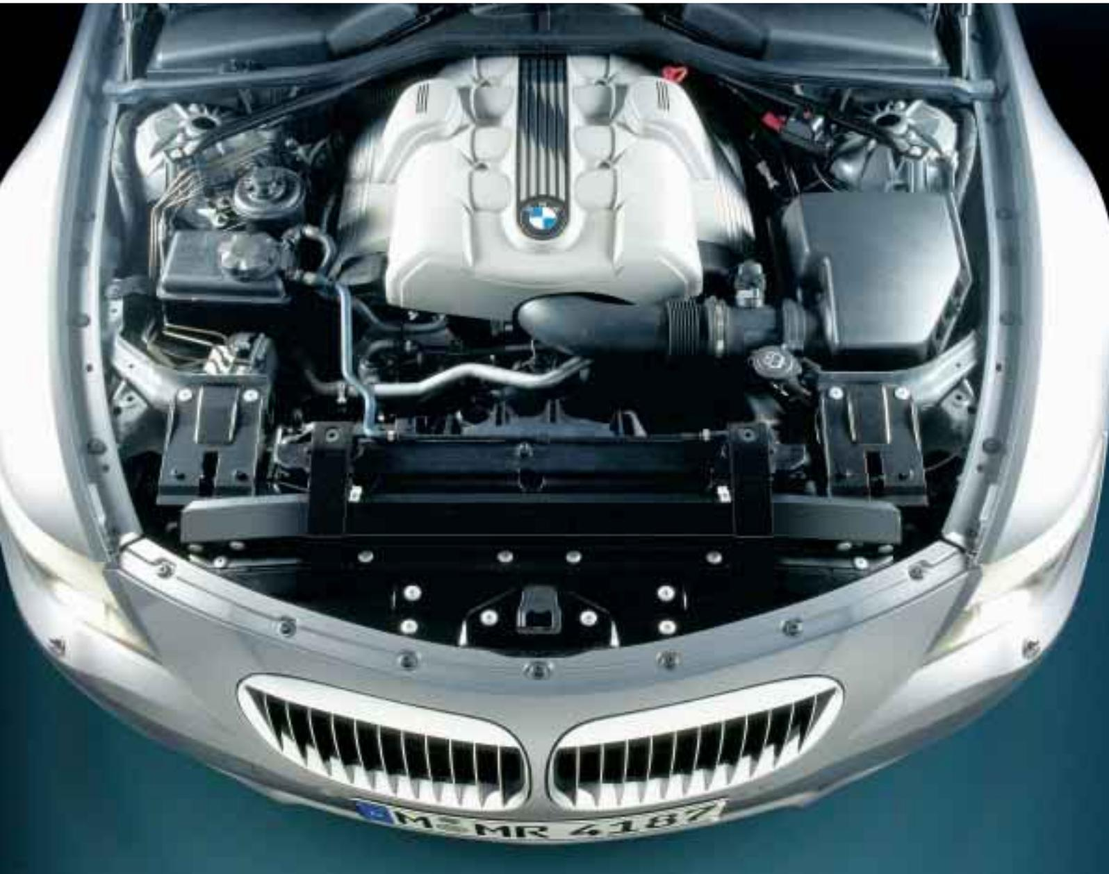
Perfekte Balance: Der gewichtsreduzierte Vorderbau aus Aluminium und der weit hinten eingebaute Motor sorgen für eine optimale Gewichtsverteilung.
