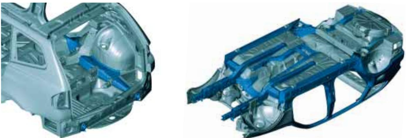
Stärker gemacht: Die Karosserie basiert auf der des 3er Touring, sie wurde aber an vielen Stellen versteift. Verstärkungsbleche in den B-Säulen schützen die Insassen bei einem Seiten-Aufprall. Die hinteren Motorträger werden aus hochfestem „Trip 700“-Stahl gefertigt.
