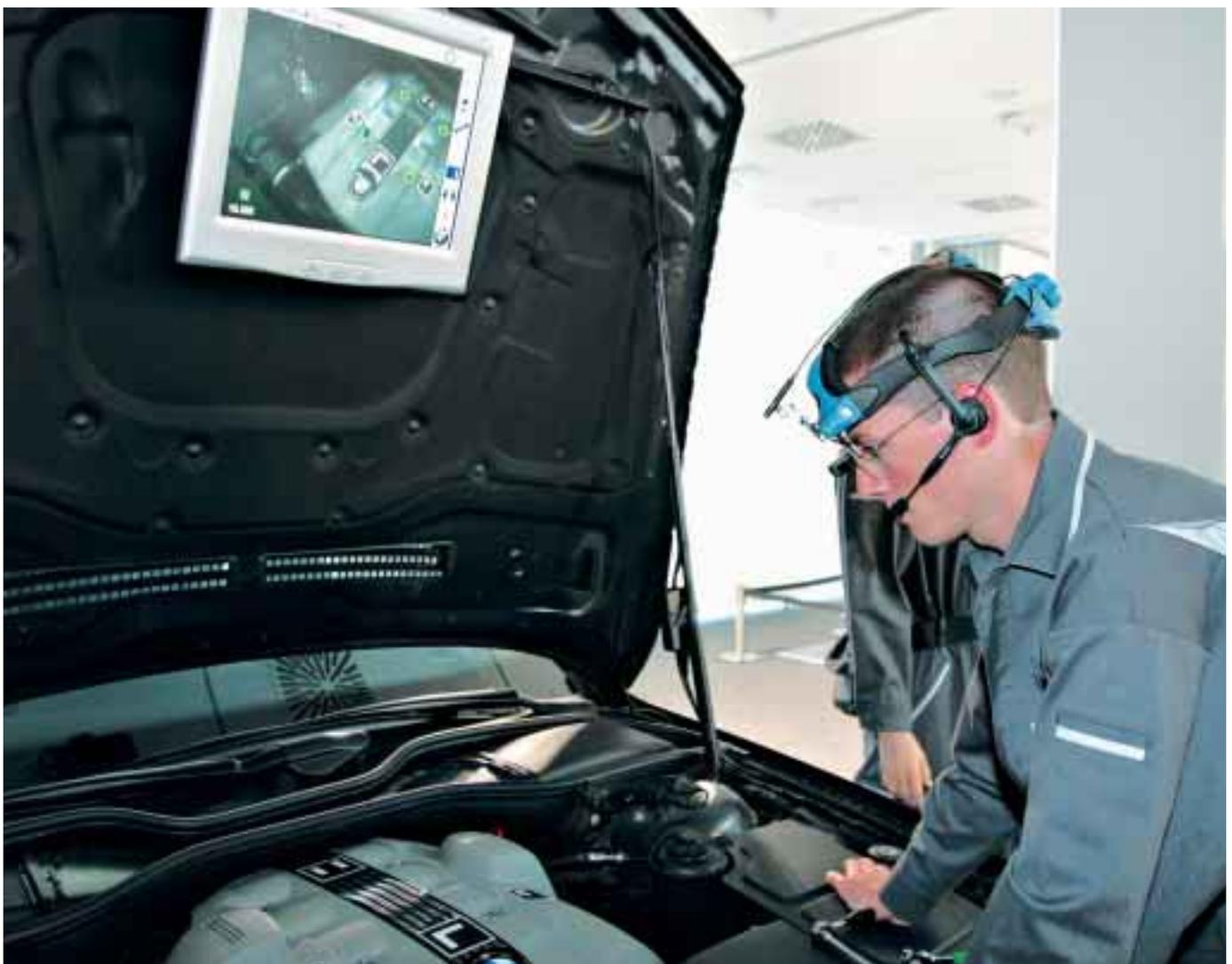
Die Werkstatt der Zukunft: Der Mechaniker ist mit einer integrierten Display-Kamera-Brille ausgerüstet, die ihn mit Informationen versorgt und ihn Schritt für Schritt durch komplexe Arbeitsabläufe führt.
