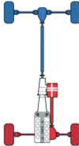
Voll variabel: Die Antriebskraft wird bei vollständig geschlossener Lamellenkupplung (links) gleichmäßig auf beide Achsen verteilt. Im Normalzustand (rechts) gelangen 40 Prozent an die Vorderachse und 60 Prozent an die Hinterachse. Im Extremfall wird das gesamte Antriebsdrehmoment an die Hinterräder geleitet.
