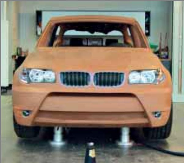
Ton in Ton: Ein Entwicklungsmodell des X3 mit Aerodynamikpaket.
