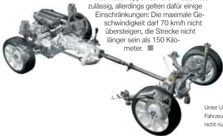
Unter Umständen nicht vollständig entkoppelt: Fahrzeuge mit xDrive dürfen zum Abschleppen nicht nur an einer Achse angehoben werden.
