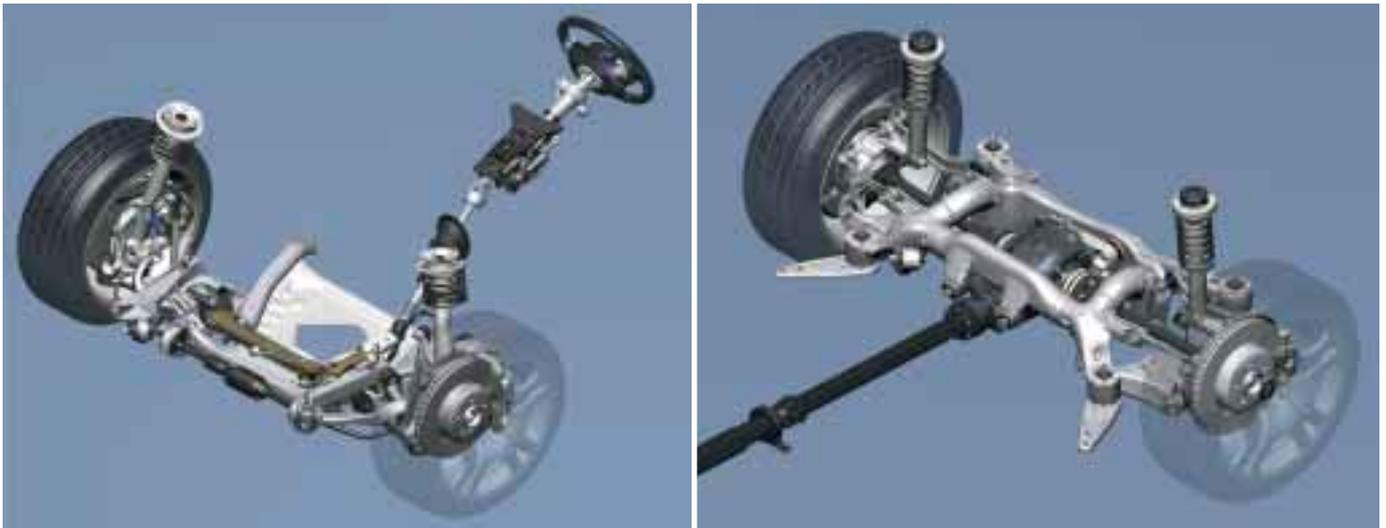
Bewährte Komponenten: Die Vorderradaufhängung und die hintere Integral-4-Achse wurden in modifizierter Form vom E60 übernommen. Die Verwendung von Aluminium für Achsträger und weitere Bauteile spart Gewicht und verbessert die Fahreigenschaften des neuen 6er Coupés.
