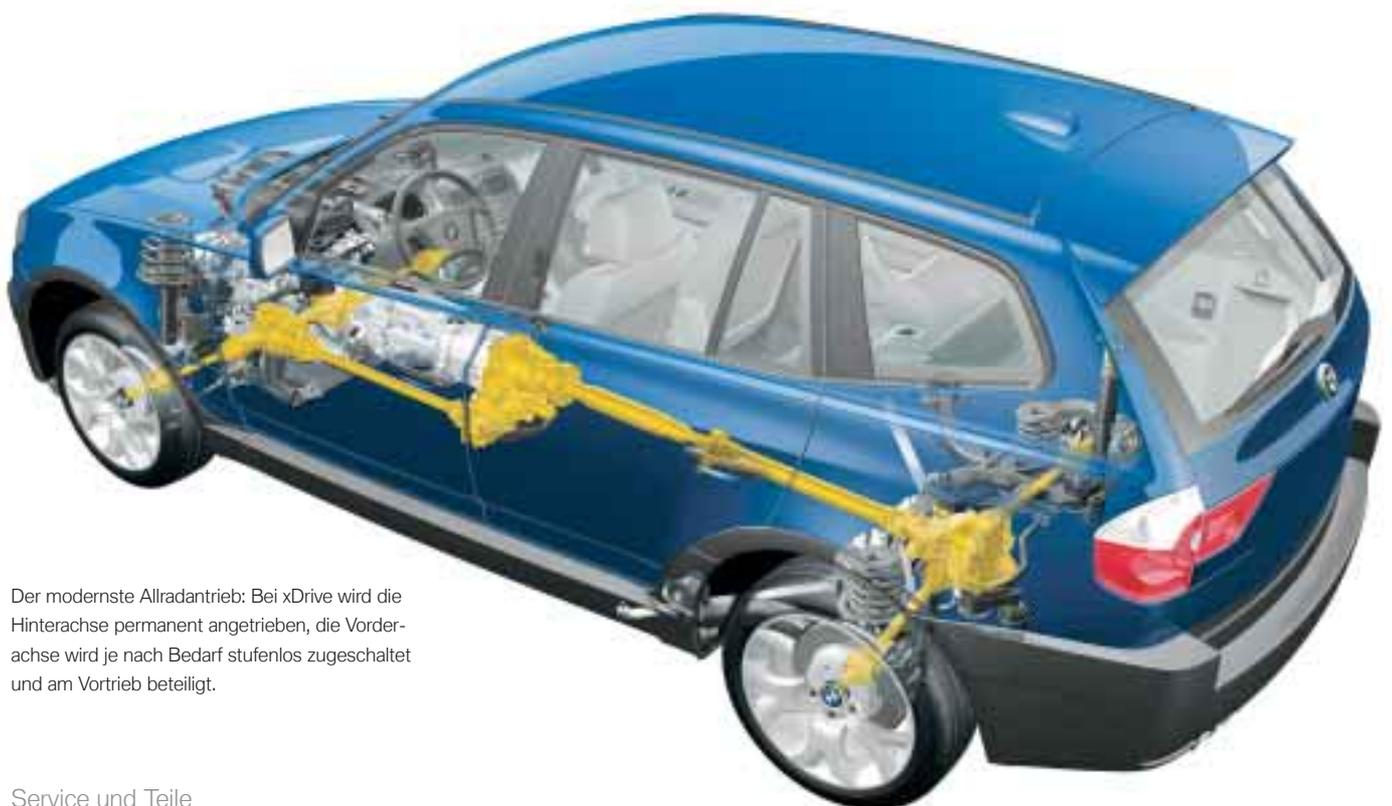
Der modernste Allradantrieb: Bei xDrive wird die Hinterachse permanent angetrieben, die Vorderachse wird je nach Bedarf stufenlos zugeschaltet und am Vortrieb beteiligt.
