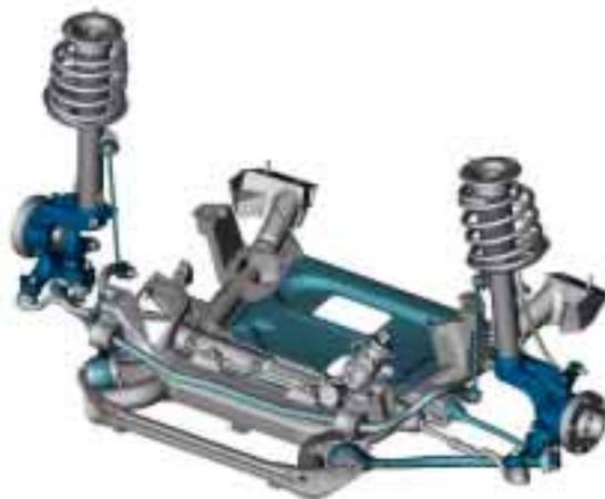
Robust genug für den Offroad-Einsatz: Die Vorderachse entspricht konstruktiv der Radaufhängung des X5. Besonders belastete Bauteile wie Querlenker, Zugstrebe und Schwenklager sind als Stahl-Schmiedeteile ausgeführt.
