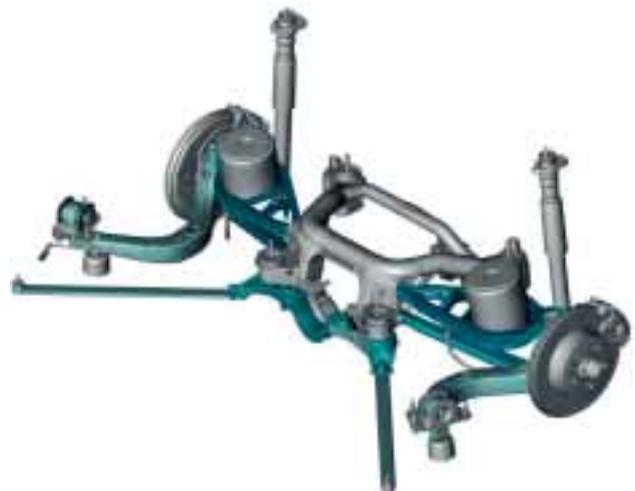
Bewährt: Die Hinterachse basiert auf dem E46 mit Allradantrieb. Die Zentralenkerachse sorgt durch obere und untere Querlenker für eine sichere Radführung und besitzt eine doppelt elastische Aufhängung für das Hinterachsgetriebe.
