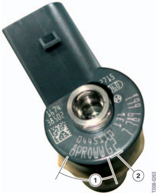
28 - Injektormengenabgleich EURO 3 zweite Ausführung
