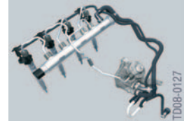
Die Kraftstoffaufbereitung ist für die Bereitstellung und Dosierung der richtigen Kraftstoffmenge zuständig. Die Kraftstoffaufbereitung wird in einen Niederdruckbereich, einen Hochdruckbereich und in eine elektrische Steuerung untergliedert.
