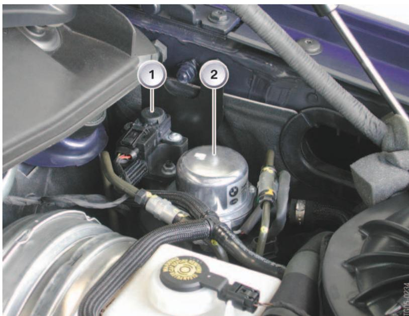
4 - Elektrische Unterdruckpumpe
