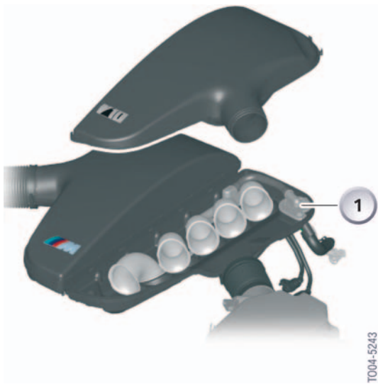
25 - Zyklonabscheider (1) im Sammler für Ansaugluft
