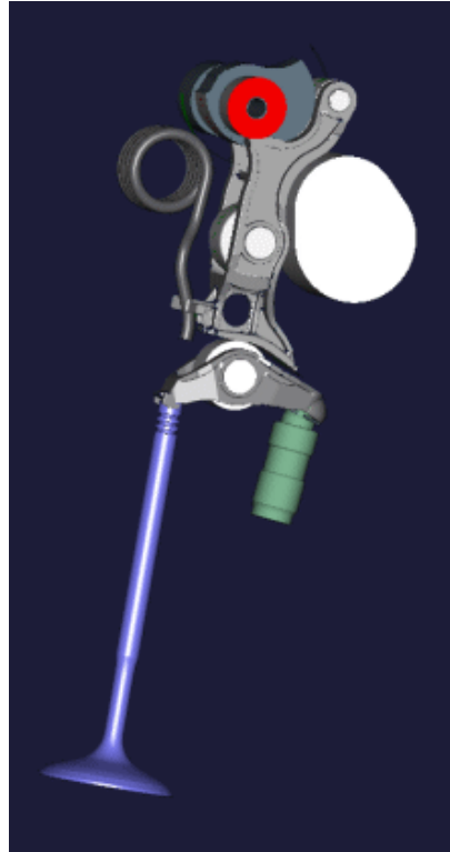
Abb. 33: Grafik der Ventilhubverstellung
