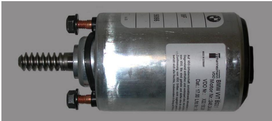
Abb. 63: Elektromotor für die Verstellung der Exzenterwellen
