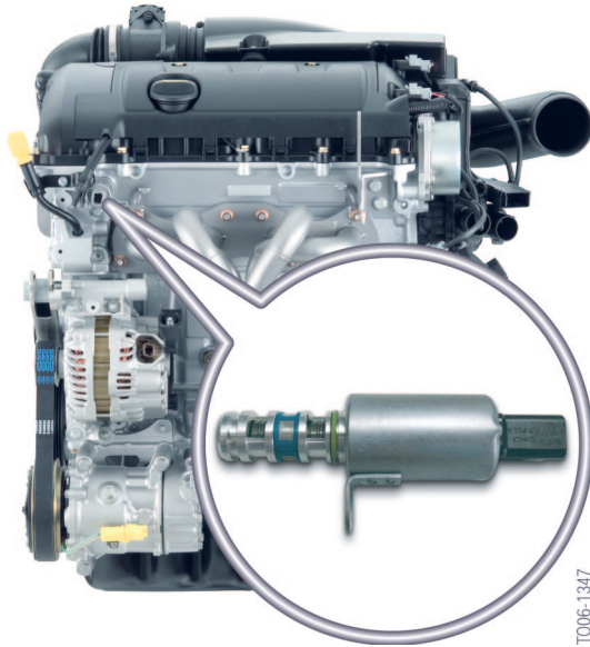
6 - Magnetventil Auslassnockenwelle N12 Motor
