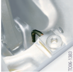
Ölspritzdüsen und Ihre Aufgaben der Kühlung und Schmierung sind heute wichtige Bestandteile eines modernen Motors.
